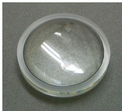
レンズ面形状 Φ60mm球面 +半面プリズム面 (丸板素材から削り出し)
